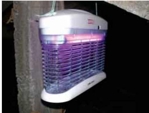
Figura 3 – Aspecto de uma armadilha luminosa para a captura dos adultos de térmitas.
